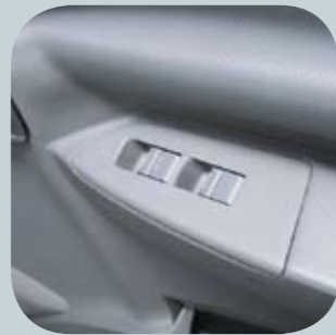
Interruttore dei finestrini (apertura automatica, chiusura manuale)
