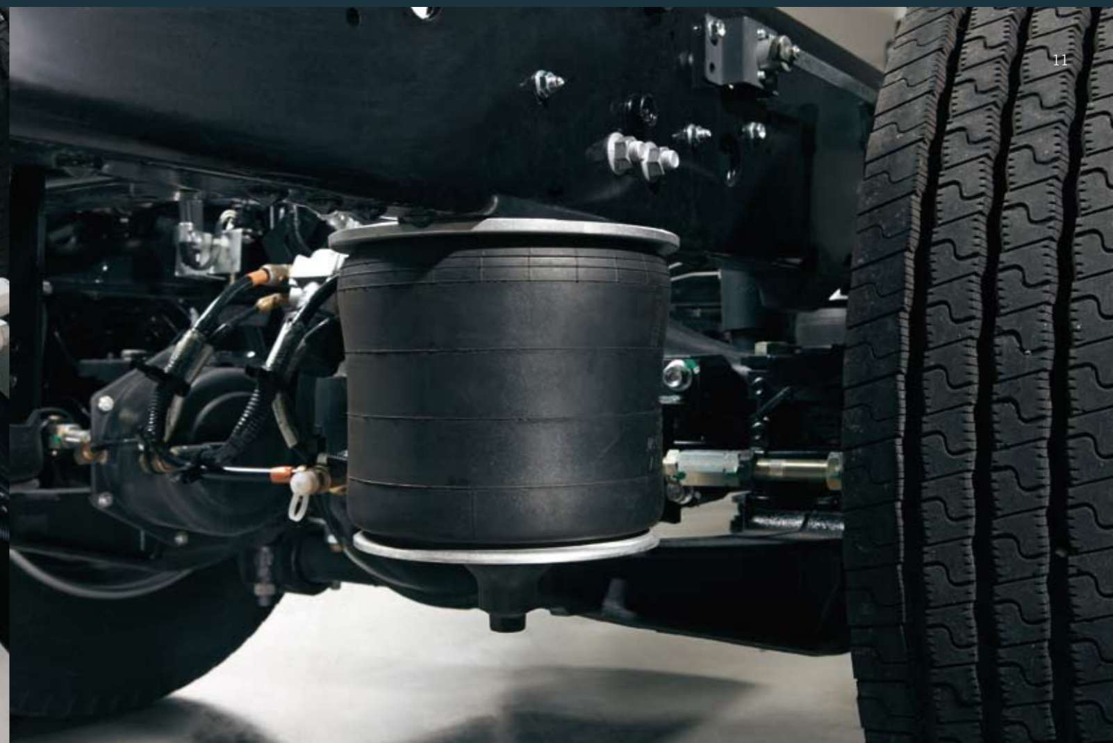
Sospensioni ad aria posteriori a 4 soffietti
